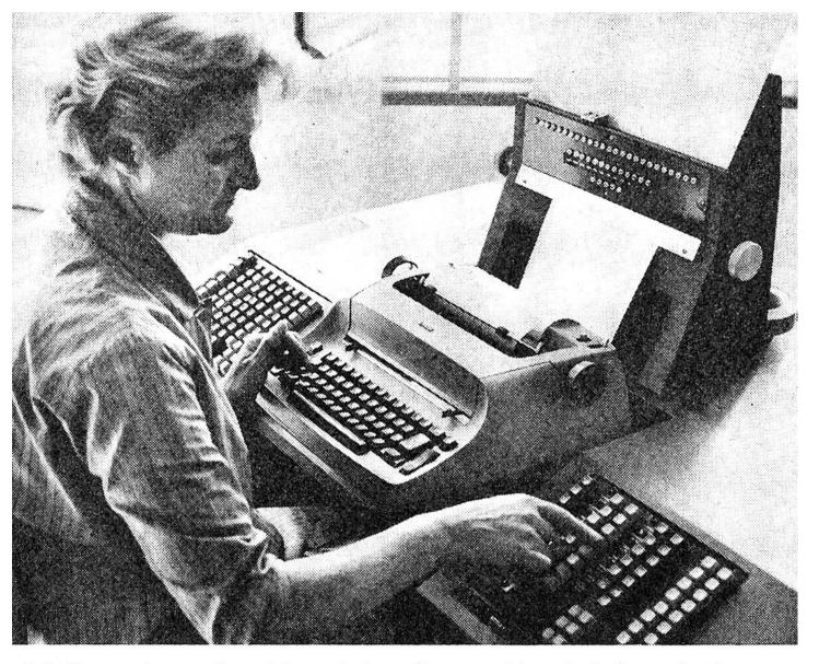
Schriftsetzerin an der elektronischen Setzmaschine. Auf dem schreibmaschinenartigen Tastgerät wird der Text getippt. Die Schalttafeln dienen zur Einstellung der gewünschten Schriftgestaltung.
