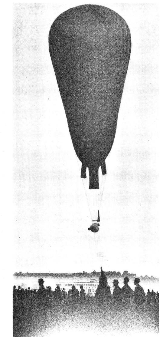
Ein Ballon trägt Piccards druckfeste Stahlkugel bis 16940 Meter hoch.
