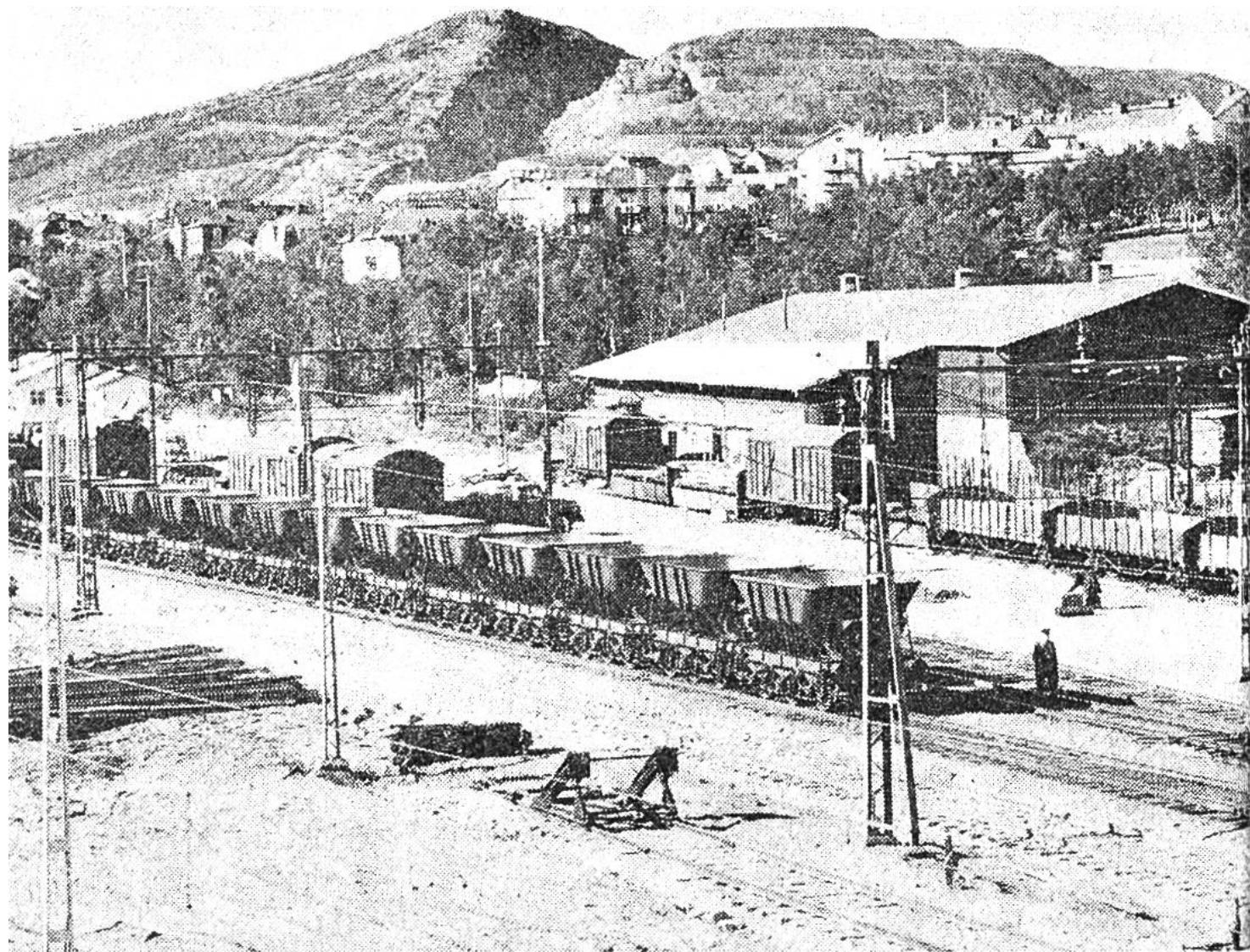
Im Güterbahnhof von Kiruna bestimmen die Spezialwagen für den Erztransport das Bild. Im Hintergrund der mitten aufgespaltene Luossavaara (ausgeräumte, in die Tiefe tauchende Erzschicht) mit dem rechts terrassenförmig aufgeschütteten Abraumgestein.
