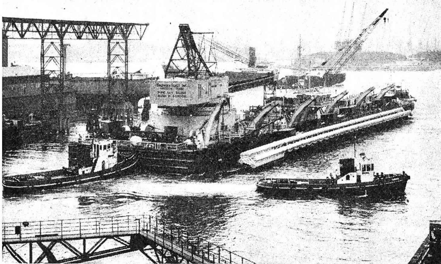
Ein für das Auslegen von Unterwasser-Pipelines konstruiertes Schiff verlässt den Hafen von Rotterdam. Es soll eine Rohrverbindung zwischen einer Erdöl-Förderinsel draussen auf dem Meer und dem Festland herstellen.
