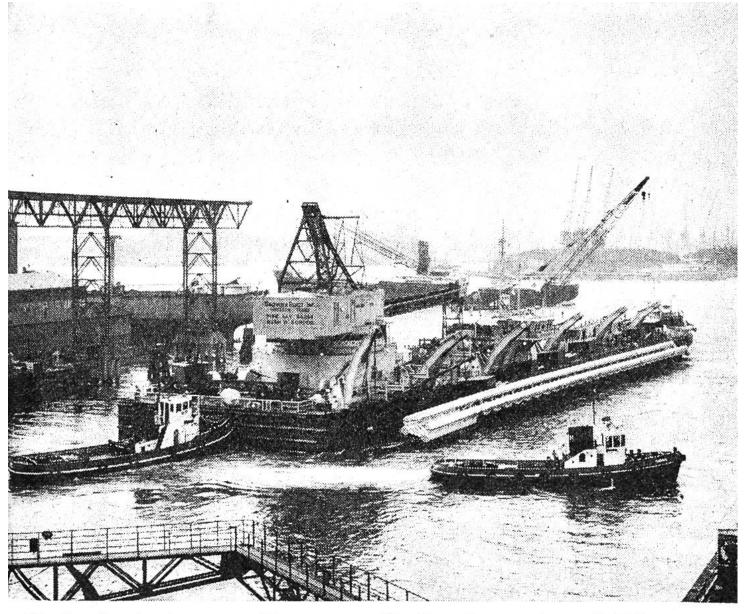
Ein für das Auslegen von Unterwasser-Pipelines konstruiertes Schiff verlässt den Hafen von Rotterdam. Es soll eine Rohrverbindung zwischen einer Erdöl-Förderinsel draussen auf dem Meer und dem Festland herstellen.
