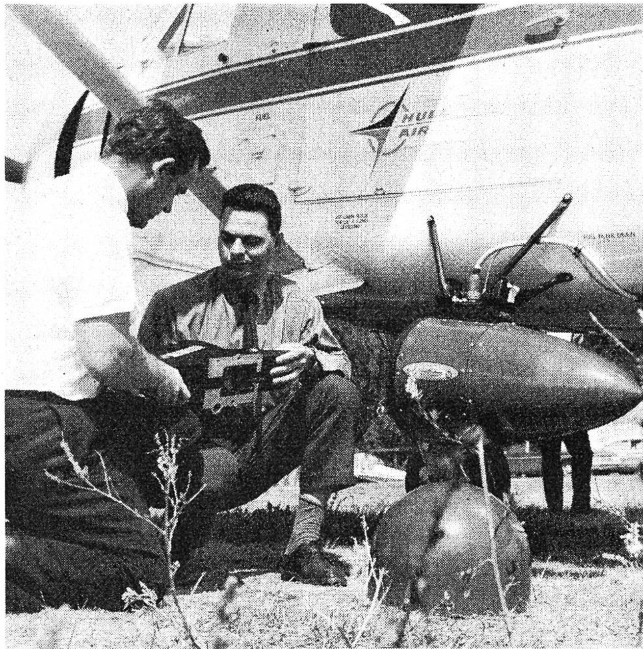
Das neue kanadische Abtastgerät ist in einem Plexiglas-Schutzgehäuse untergebracht. Hier wird soeben eine neue Filmkapsel eingesetzt. Bald findet der nächste Kontrollflug statt.
