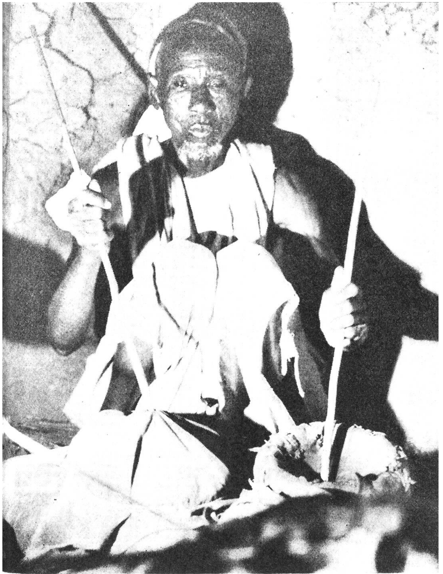
Die notwendige Gluthitze erreicht man mit Hilfe eines Schalenblasbals.
