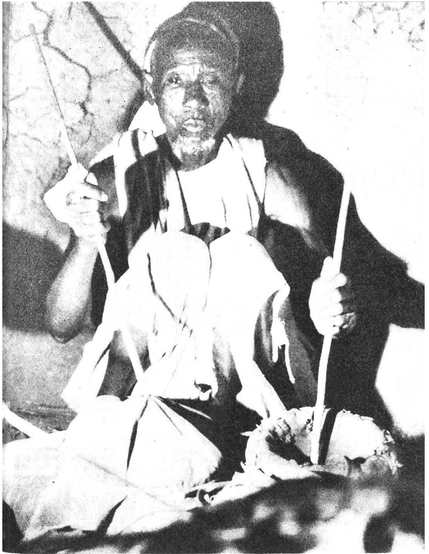
Die notwendige Gluthitze erreicht man mit Hilfe eines Schalenblasenbals.
