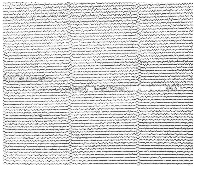
Die normale Seismographenkurve auf dem Papierstreifen wird stellenweise durch bedeutend stärkere Ausschläge unterbrochen. Die 1200 Seismographenstationen der Erde registrieren im Laufe eines Jahres etwa eine halbe Million Beben, jede mehrere im Laufe eines Tages.
