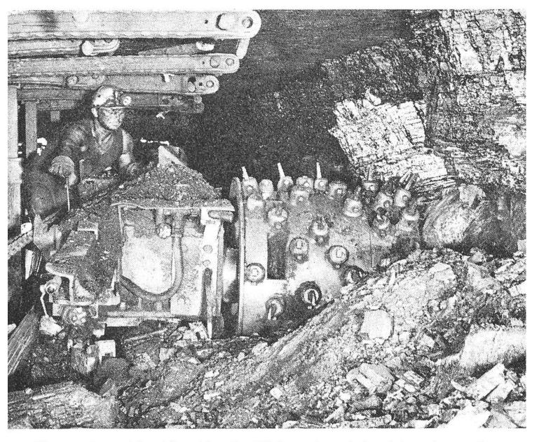
Eine moderne Maschine, hier der Walzenschrämlader, leistet heute die Arbeit von etlichen Kumpels, aber diese mechanischen Hilfen lassen sich nicht überall einsetzen.
