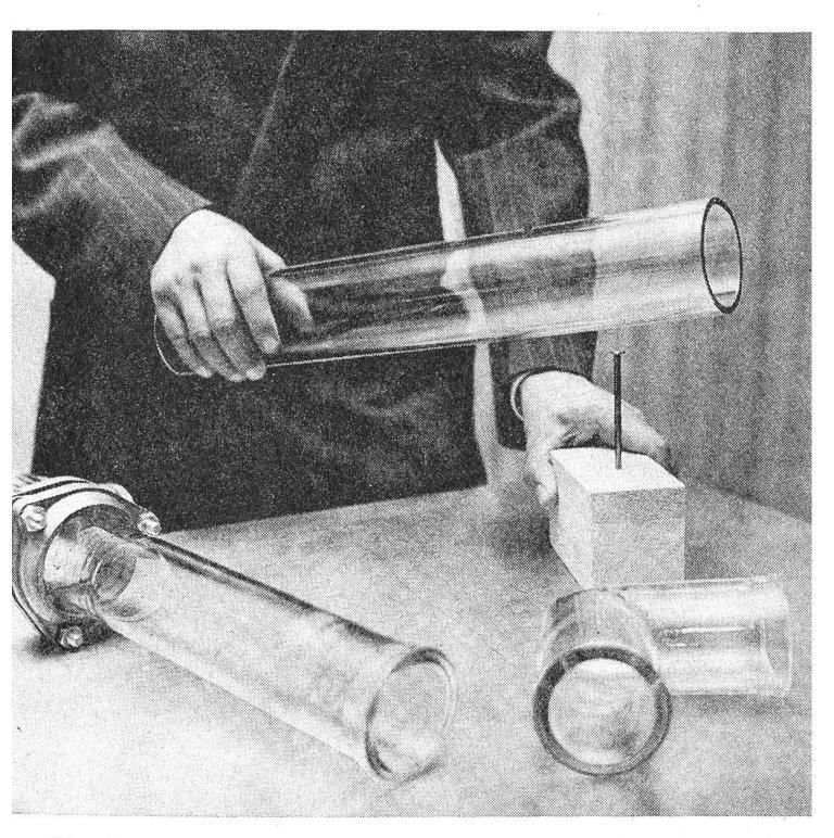
Einst hätte man es als Verrücktheit bezeichnet, einen Nagel mit einem Glasrohr einschlagen zu wollen. Heute hat man keine Scherben mehr zu befürchten, vorausgesetzt, dass man das neue, unzerbrechliche Glas dazu verwendet.
