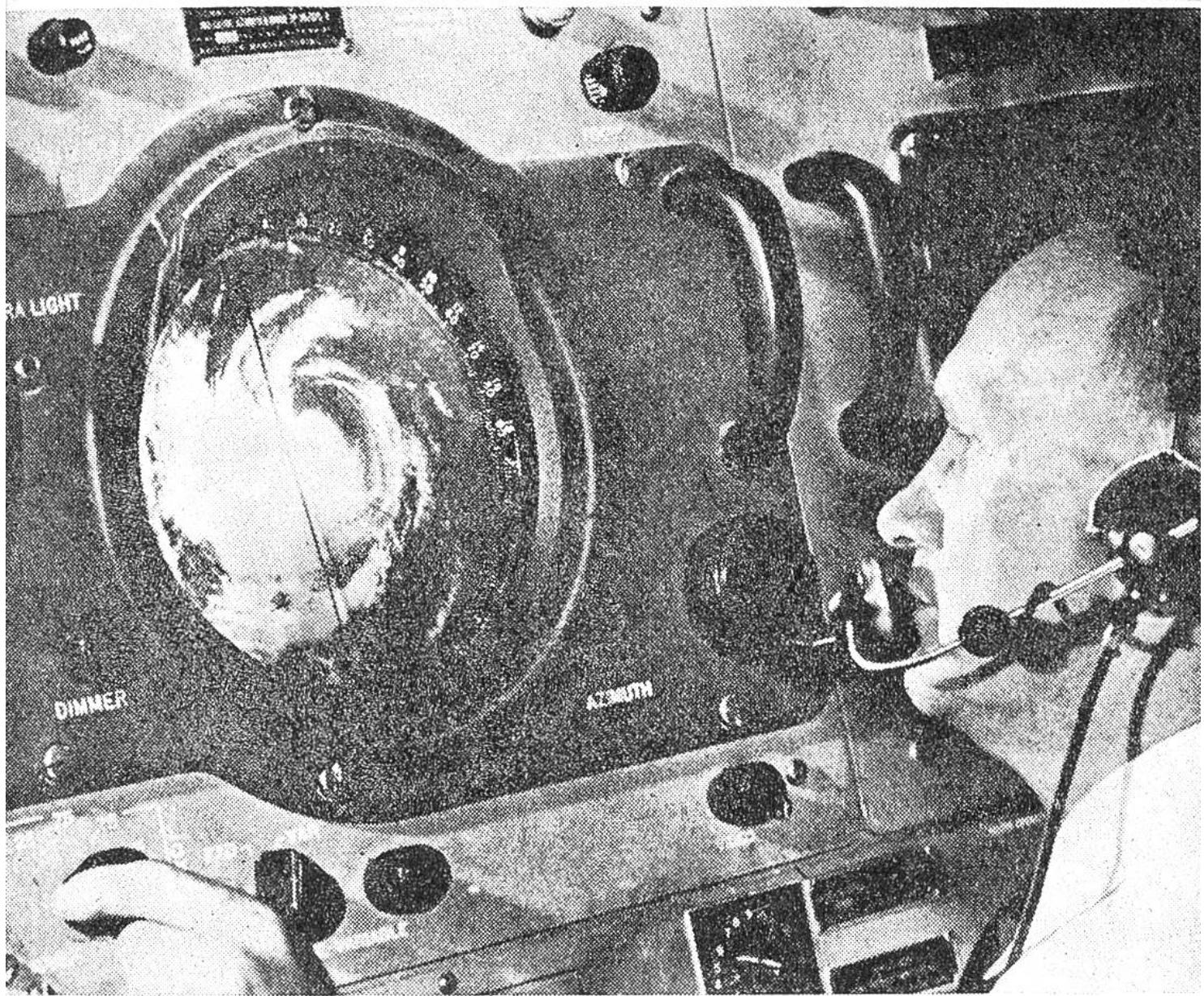
In einer der 39 Radarstationen, die zum Sturmwarnungsnetz gehören, zeichnet sich auf dem Schirm eines starken, weitreichenden Gerätes die Teufelsspirale des heranbrausenden Hurrikans deutlich ab.
