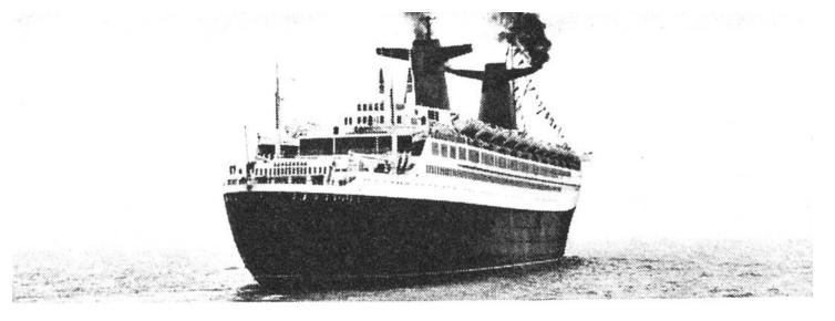
Wie Flügel muten auf diesem Bild die Anbauten an den beiden Kaminen an. Sie sollen verhindern, dass Russ und andere Verbrennungsrückstände aufs Schiff fallen.
