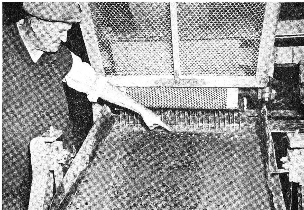
Die Diamanten-Auswaschmaschine, in der die Edelsteine von den übrigen Steinen und vom Sand getrennt werden.
