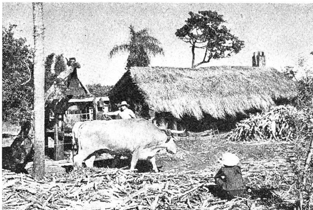
Zuckerrohr wird ausgepresst und der zuckerhaltige Saft gewonnen, der dann durch Kochen zu braunem Zucker eingedickt wird.
