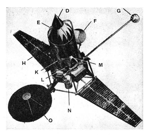
Rechts: Modell eines Ranger-Satelliten, der zur Erforschung des Mondes abgeschossen werden soll. D= Richtantenne, E= Mondkapsel, F= Radar-Höhenmesser, G= Gammastrahlen-Spektrometer, H= Sonnenbatterien, K= Wärmeschutzhülle, L= Kursberichtigungsmotor, M= Rückstossrakete, N= Fernsehkamera, O= Parabolspiegelantenne.
