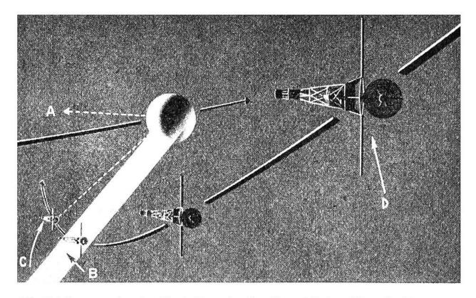
Die Zeichnung zeigt den Vorbeiflug des Satelliten Mariner II an der Venus am 14. Dezember 1962 in einer Entfernung von 33600 km (C), als es zum erstenmal in der Geschichte der Menschheit gelang, verschiedene Messungen über den Zustand eines Planeten vorzunehmen. A = Sonne, B = Zone, in der die Messungen vorgenommen wurden, D = Mariner nähert sich 30° von oben und hinter der Venus.
