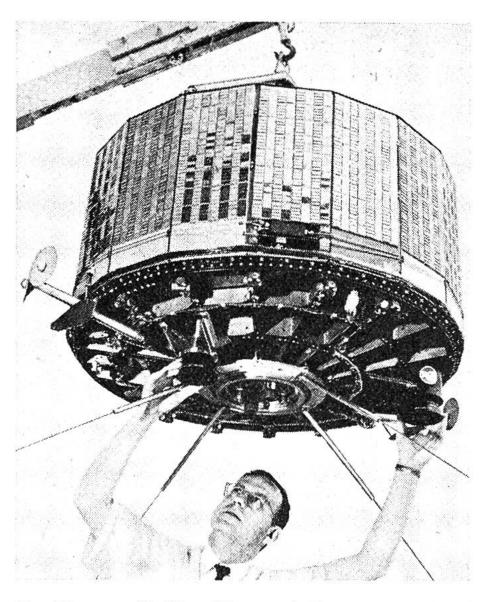
Der Wettersatellit Tiros III war mit Geräten ausgerüstet, welche die infrarote Wärmestrahlung der Wolkendecke über der Erde registrierten und der Beobachtungsstation meldeten. Seine Oberfläche ist mit Sonnenbatterien bedeckt, die das Sonnenlicht in elektrischen Strom umwandeln, um die Apparate und Sendeeinrichtungen des Satelliten zu speisen.
