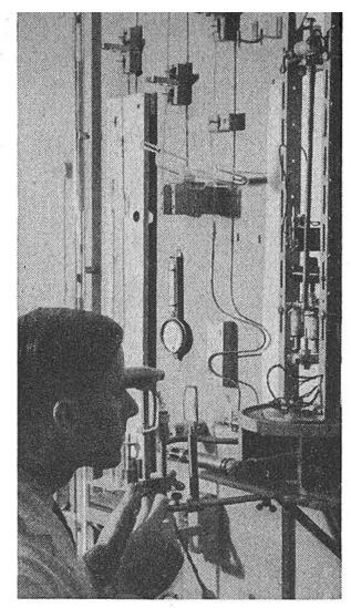
Messung der Schwingungsdauer eines freidrehenden Torsionspendels unter wechselnden Druckverhältnissen.
