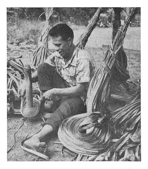
Da in Tahiti beim Hausbau keine Nägel verwendet werden, müssen ungezählte Meter biegsamer Gurten aus Rinde zum Befestigen der Balken bereitgestellt werden.
