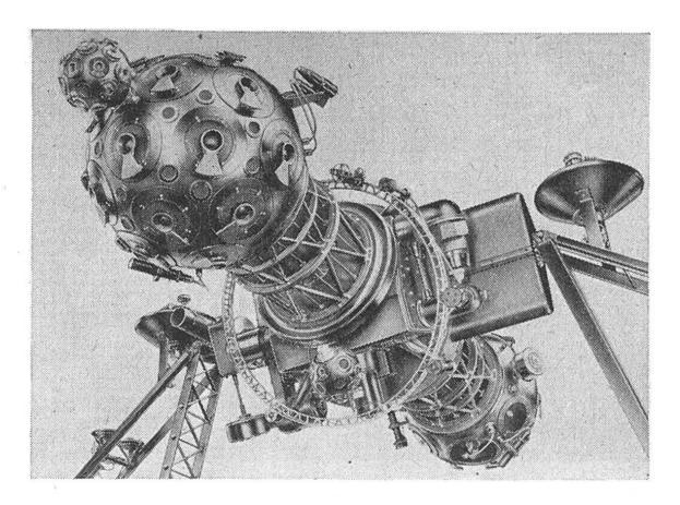
Das grosse Instrument im Mittelpunkt des Zeiss-Planetariums ist ein äusserst kompliziertes Projektionsgerät, das etwa 5 m hoch ist,  $2\frac{1}{2}$  Tonnen wiegt und sich nach allen Seiten drehen lässt. Mit seinen 32 Projektoren werden rund 9000 Fixsterne wiedergegeben, wozu noch besondere Projektionsmechanismen für Sonne, Mond, Planeten und die verschiedenen Himmelslinien kommen.
