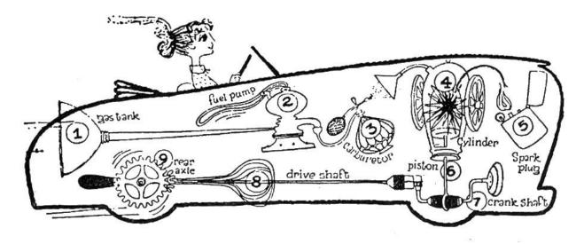
So lernen die Indianer das Geheimnis des Automotors kennen! Der Trichter (1) ist der Benzintank, die Pumpe (2) befördert das Benzin in den Motor, wo der Zerstäuber (3) die Flüssigkeit und die Luft in den Zylinder (4) einbläst. Das Feuerzeug (5) liefert den Funken für die Explosion, wodurch der Kolben (6) heruntersaust und den Bohrer (7) dreht. Dadurch dreht sich auch der Schaumschläger (8 und 9), der seine Kraft auf die Autoräder überträgt.
