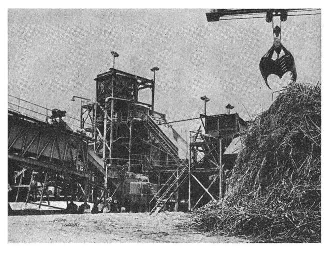
Die geernteten Zuckerrohrstengel werden im Fabrikhof zu Haufen geschichtet. Am Kran befindet sich ein Greifer, der die Stengel zur Wäscherei und zu den Pressanlagen befördert.
