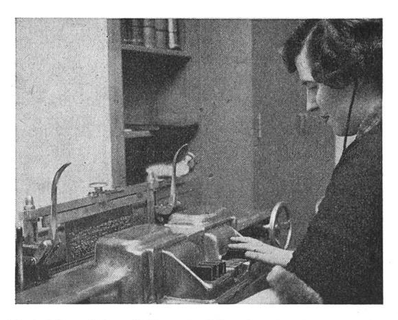
Die blinde Sekretärin hört die Texte vom Diktaphon ab und überträgt sie sicher auf die Braille-Setzmaschine.
