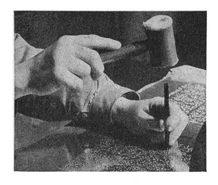
Der Korrektor arbeitet mit Metallstift und Holzhammer, um falsche Punkte flachzuschlagen oder neue auszustanzen.
