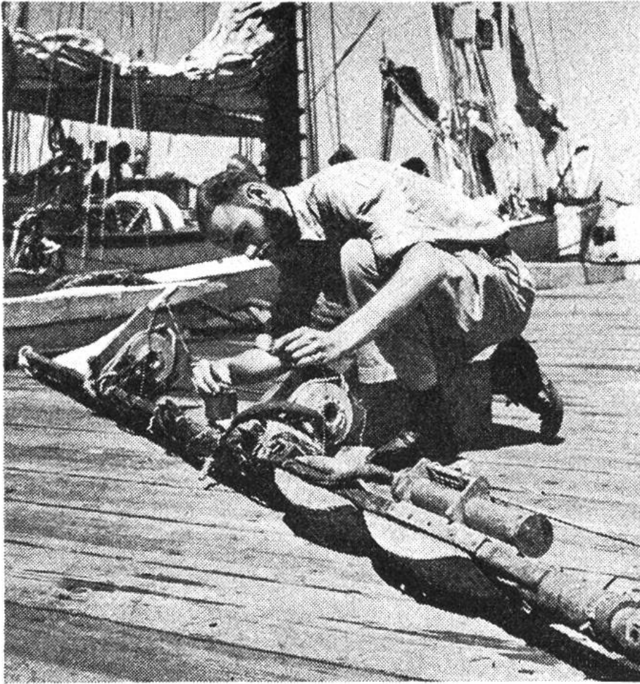
Eine Unterwasserkamera. Beim Auftreffen auf den Grund wird sie automatisch ausgelöst. Selbstverständlich ist sie mit Blitzlicht ausgerüstet.
