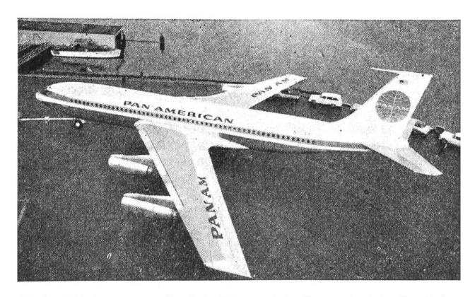
Boeing 707, das erste amerikanische Düsenverkehrsflugzeug im Atlantikverkehr. 122–147 Passagierplätze, 4 Düsentriebwerke und eine Reisegeschwindigkeit von über 900 km/h bilden den Standard heutiger Langstreckenmaschinen.
