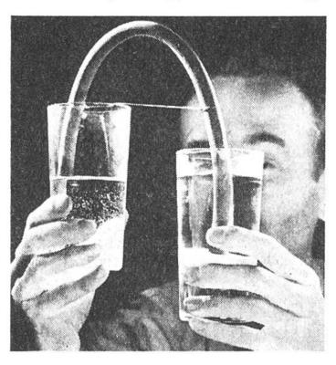
wie bei einer beidseitig gleich belasteten Schalenwaage im Gleichgewicht. Wird das eine Glas gesenkt, so verlängert sich die Wassersäule im betreffenden Heberschenkel, und es entsteht ein Übergewicht, das sich durch Abfliessen von Wasser bis zur Erreichung der Niveaugleichheit des Wassers in beiden Gläsern wieder ausbalanciert.
