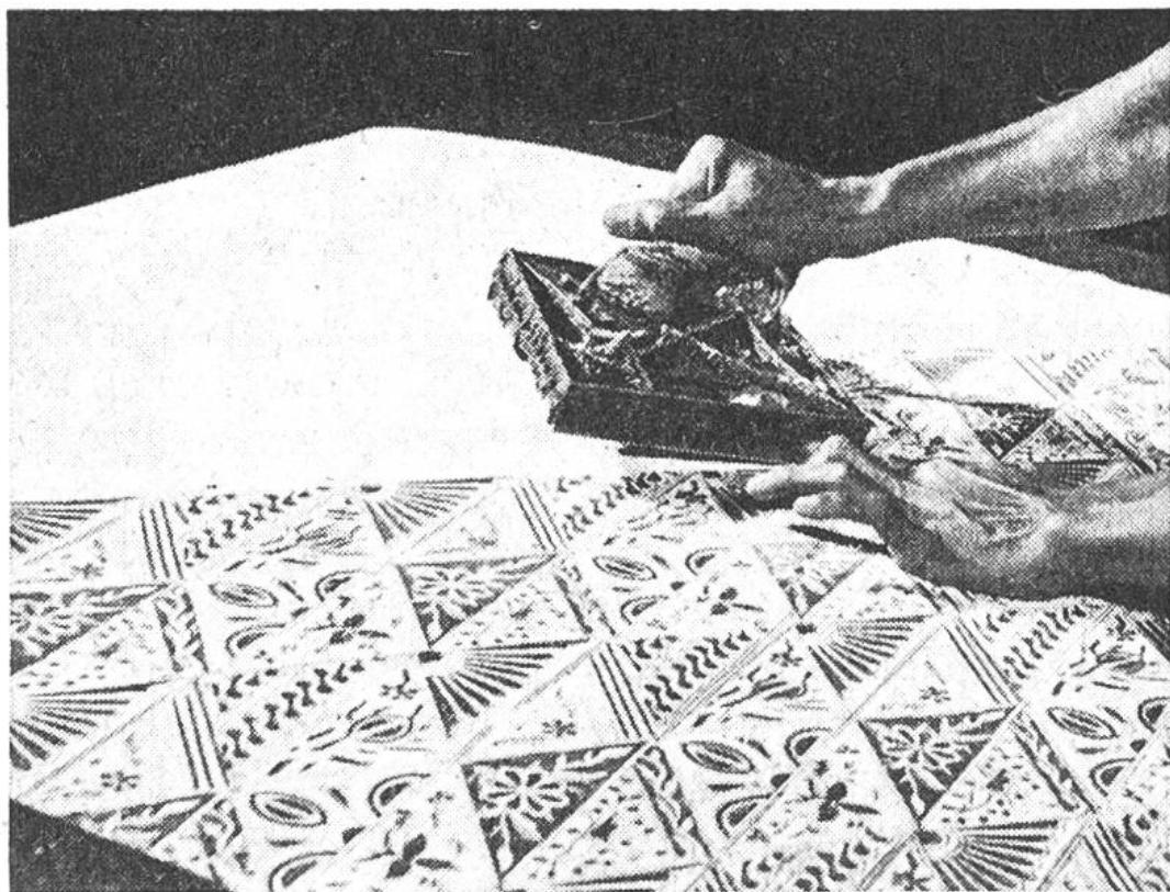
Schneller geht es mit Hilfe eines kupfernen Stempels, den man in geschmolzenes Wachs eintaucht und dann auf das Tuch aufdrückt. Eine Schicht aus Wachs unter dem Stoff schmilzt an den Stellen, wo es mit dem heißen Metall in Berührung kommt, so dass der Stoff beidseitig mit Wachs durchtränkt wird.
