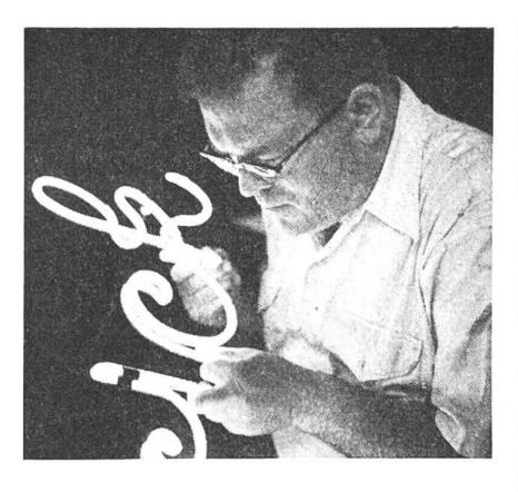
Sobald die Neonröhre an den Enden verschmolzen und mit Kontakten versehen ist, wird sie unter Strom gesetzt, um auf Undichtigkeiten und schadhafte Stellen untersucht zu werden.
