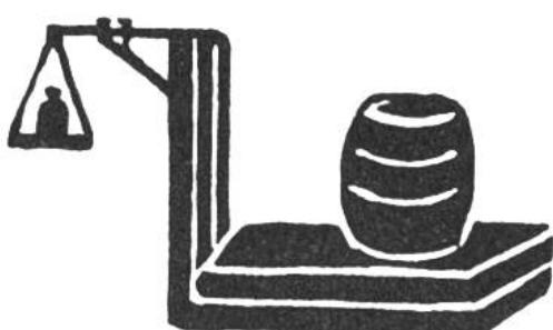
durch Hebel so auf den Waagbalken, dass das aufgelegte Gewicht nur den zehnten Teil der Last zu betragen hat (daher Dezimalwaage).
