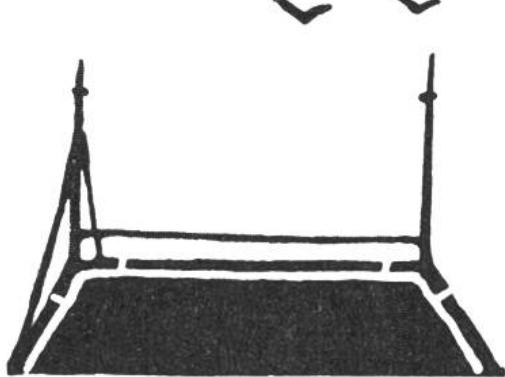
**1752** baute der Amerikaner Franklin den ersten Blitzableiter. Nach Experimenten über die elektrische Spitzenwirkung und Versuchen mit Papierdrachen während eines Gewitters kam Franklin auf die Idee, «Häuser und Schiffe durch Blitzableiter zu schützen». Er verband eine das Haus überragende Metallstange mit der Erde. 1760 erhielt der Eddystone-Leuchtturm vor Plymouth den ersten Blitzableiter in Europa.
