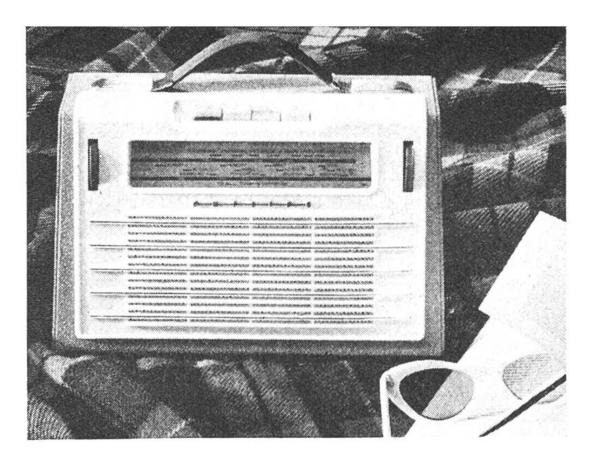
Dieser Transistor-Empfangsapparat gehört nicht zu den kleinsten Typen, dafür bietet er ohne Auswechseln der Batterien während rund 800 Stunden den Nah- und Fernempfang von Mittel- und Kurzwellensendern bei überraschend guter Tonqualität. (Philips)
