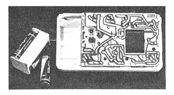
Dank der Verwendung von Transistoren und gedruckten Schaltungen können gute, lautstarke Empfangsapparate konstruiert werden, die nicht viel grösser sind als eine Zigarrendose. (Telefunken)
