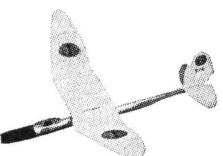
Flugmodell «Söniz» mit Gummimotor, Stahldraht sehr solid
