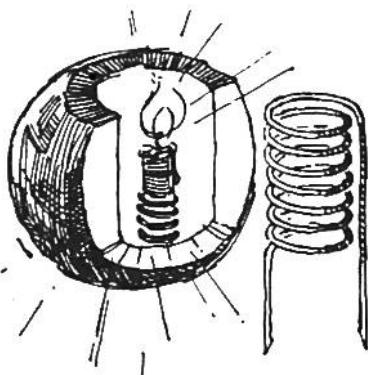
Ein ca. 20 cm langes Stück Aluminiumdraht wird um einen Holz- oder Eisenstab von ca. 15 mm Durchmesser, je nach Kerzendiffe, spiralenförmig gewickelt (– und wieder abgenommen). Die beiden Enden werden nach unten gebogen, so, dass sie etwa 1 cm vorstehen. Diese Enden werden in den Boden der Räbenlampe gesteckt, und die Kerze kann in den Halter gedreht werden.
