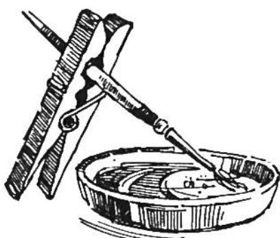
Will man einen Pinsel in einem Näpfchen Terpentinöl reinigen, wird er wegen des langen Stieles immer wieder herausfallen und den Tisch beschmutzen. Man klemme daher das Ende des Stiels in eine Wäscheklammer; die Spitze des Pinsels wird dann in der Flüssigkeit bleiben. Man sollte den Pinsel nicht in ein Glas stellen; denn die Pinselspitze wird durch das Umbiegen beschädigt.
