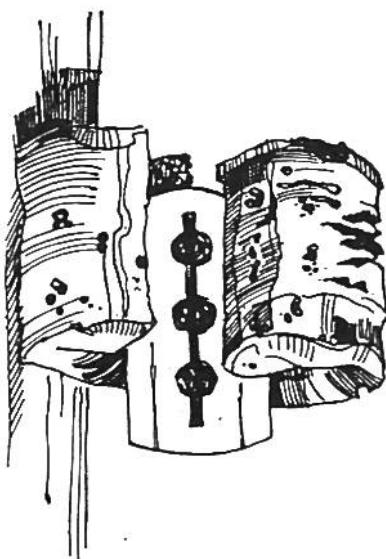
Um eine Rasierklinge an einem sicheren Platz in der Werkstatt aufzubewahren, schneidet man am besten einen tiefen V-förmigen Schlitz in einen grossen Korkzapfen und klebt diesen an eine Wand in der Nähe der Werkbank. Zur Sicherung steckt man einen zweiten Kork auf die andere Schneide der Rasierklinge.
