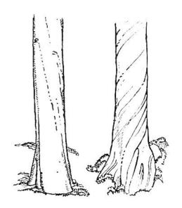
Drehwuchs als Holzfehler. Drehwuchs ist ein häufiger Fehler bei Rot- und Weisstanne, Lärche, Föhre, Eiche, Hagebuche, Ulme, Kastanie, Pappel und Birnbaum; niemals jedoch weist die Birke Drehwuchs auf. Von rechts unten nach links oben gedrehte Stämme nennt der Förster links oder «sonnig» gedreht; laufen die Holzfasern dagegen von links
