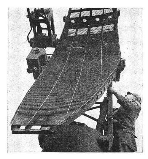
Die Radar - Antenne besitzteinen parabolischen Spiegel aus Metallstäben, der die elektrischen Wellen wie den Strahl eines Scheinwerfers zusammenfasst und aussendet.
