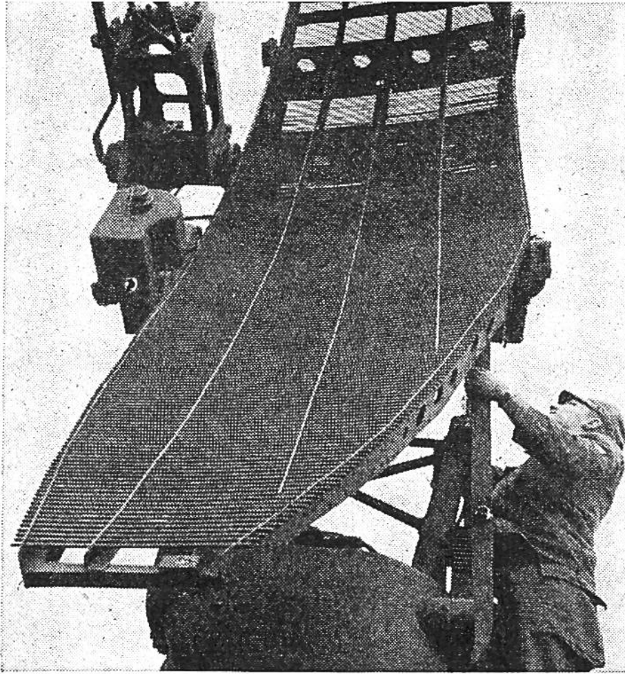
Die Radar - Antenne besitzt einen parabolischen Spiegel aus Metallstäben, der die elektrischen Wellen wie den Strahl eines Scheinwerfers zusammenfasst und aussendet.
