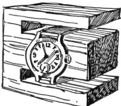
**Halter für die Armbanduhr.** Nach Mitteilung von Albert Amacher, 12 Jahre, Bern. Der hier abgebildete Uhrenhalter ist aus einem Stück Holz zurechtgesägt worden. Gefärbt oder gelackt sieht er noch netter aus. Wird die Armbanduhr eingeschoben, entsteht eine praktische Nachttischuhr.
