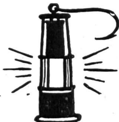
Flamme mit engmaschigem Drahtnetz, das die Flamme schützt. Er erkannte auch, dass Gasgemische in einer engen Röhre nicht explodieren.
