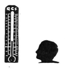
1714 stellte Fahrenheit in Danzig die ersten brauchbaren Quecksilberthermometer her. Zum Messen der Temperaturen wurde am Thermometer eine Skala angebracht. Als Fundamentalpunkte galten der Schmelzpunkt des Eises und der Siedepunkt des Wassers. Der Abstand zwischen diesen Punkten wurde von Fahrenheit in 180
