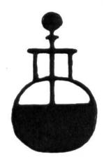
1745 erfand E. J. v. Kleist in Pommern den ersten Apparat zur Ansammlung und Verstärkung von Elektrizität. Unabhängig von ihm baute kurze Zeit später Cunaeus in Leiden den gleichen Apparat, von nun an «Leidener Flasche» genannt. Durch Aneinanderreihen von mehreren Leidener Flaschen entstand eine elektrische Batterie. Bé-
