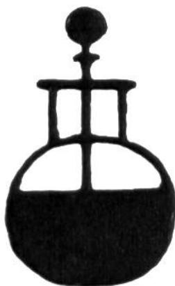
**1745** erfand E. J. v. Kleist in Pommern den ersten Apparat zur Ansammlung und Verstärkung von Elektrizität. Unabhängig von ihm baute kurze Zeit später Cunaeus in Leiden den gleichen Apparat, von nun an «Leidener Flasche» genannt. Durch Aneinanderreihen von mehreren Leidener Flaschen entstand eine elektrische Batterie.
