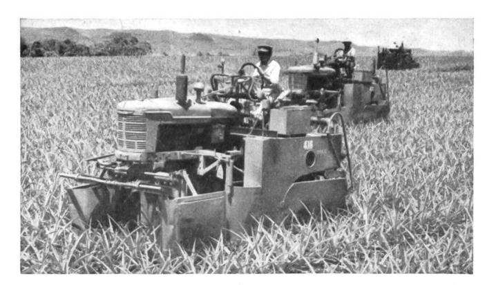
Zur Bekämpfung des Unkrautes werden hochrädrige Traktoren benützt, welche Unkrautbekämpfungsmittel in die Reihen der jungen Ananaspflanzen spritzen, während das zwischen den Reihen wachsende Unkraut auf mechanische Weise entfernt wird.
