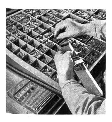
Der Metteur hält den Winkelhaken, in dem er die einzelnen Buchstaben zu Worten zusammenstellt. Jedes Fach des Setzkastens ist mit den gleichen Buchstaben angefüllt. – Auf dem Tisch links der Satz einer Seite des Kalenders: Text und Bleiklötze («Stege»); letztere füllen den Raum des später einzufügenden Klischees. Eine Schnur hält den Satz zusammen.
