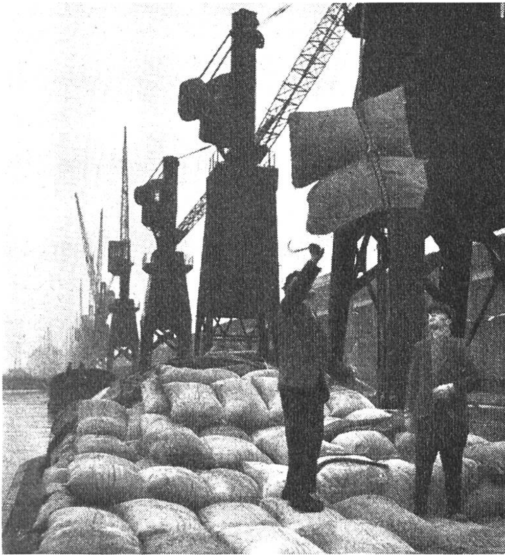
Diese Krane fahren auf Schienen und entladen die Schiffe direkt in Eisenbahnwagen. Hier wird Gerberlohe ausgeladen.
