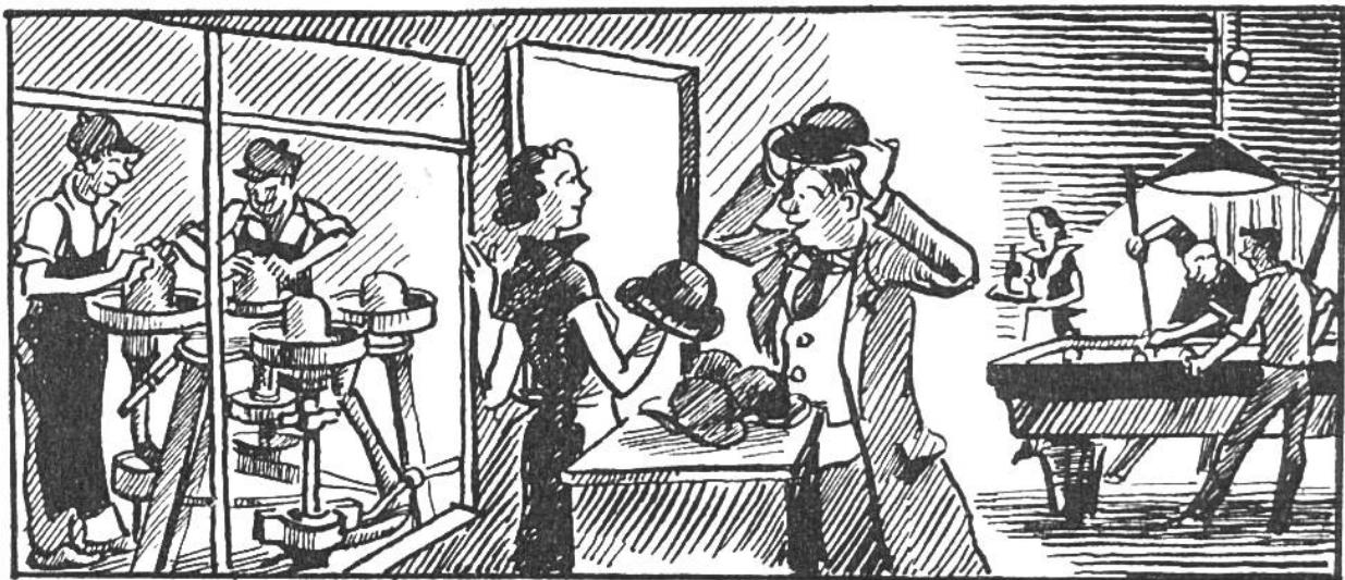
**Filz** besteht aus Schafwolle oder ähnlichen tierischen Fasern. Die Woll- oder Haarteilchen werden unter Einwirkung von Seife und anderen Stoffen sowie heissen Dämpfen zu einer zusammenhängenden Schicht vereinigt und diese durch Pressen zwischen Walzen gefestigt. Schon die alten Griechen kannten die Technik des Filzens. Das Material wird hauptsächlich verwendet für Filzhüte und Filzschuhe sowie für Wärme-Isoliermittel und Filztücher (auf Billardtischen).
