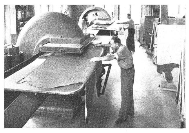
Durch Öldruck bewegte (hydraulische) Pressen, die zum Einprägen eines Narbenbildes oder aber nur zum Glätten des Leders dienen.
