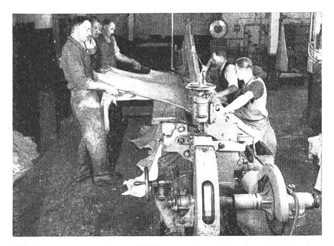
Häute von ausgewachsenen Rindern werden, sofern sie zu leichten Ledern verarbeitet werden, mittels einer Maschine gespalten. Im Vordergrund ist das Bandmesser sichtbar, das die Haut in zwei Schichten trennt.
