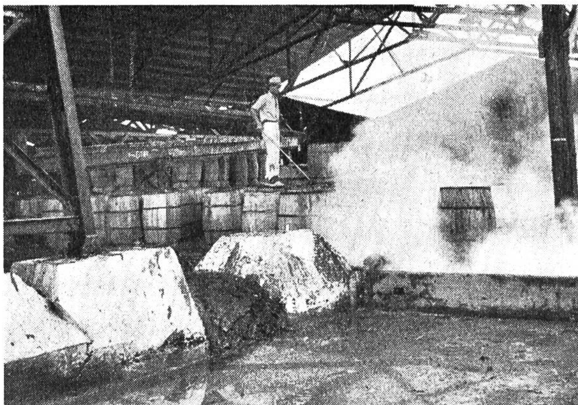
In der am Ufer gelegenen Fabrik wird der Asphalt zusammen geschmolzen und in Fässer abgefüllt. Ein Arbeiter geht von Fass zu Fass und stösst mit einem Stock in die Masse, um entstandene Luftblasen zu zerstechen.
