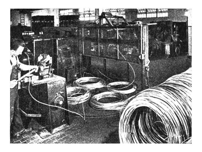
Drahtziehwerk. Die einzelnen Rollen Walzdraht werden zu einem endlosen Stück elektrisch verschweisst und bis zum gewünschten Durchmesser ausgezogen.
