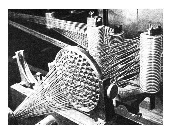
Amerikanische Herstellungsart. In einer siebartigen Vorrichtung wird die jeweils erforderliche Anzahl von Drahtpaaren zu einer Kabeleinheit zusammengefügt.
