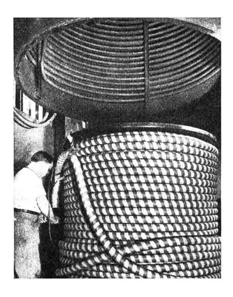
Trockengefäss mit elektrischer Heizung der Leiter zur Va-kuumtrocknung von Kabeln.
