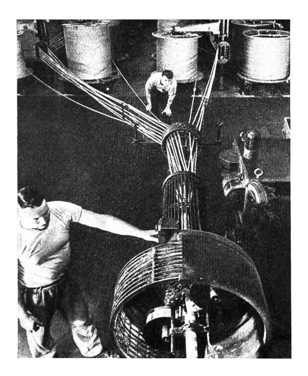
Aus 18 Kabeleinheiten (siehe vorstehendes Bild) wird ein Hauptkabelstrang gebildet, wobei dieser im gleichen Arbeitsgang eine Schutzhülle aus Papier erhält. Solche Kabel enthalten bis 2500 Aderpaare.
