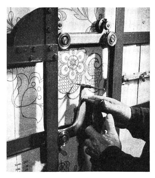
Für die Automat-Maschine muss zunächst eine Punchrolle gelocht werden. Auf dem Stickautomaten wird diese wie bei einer Jacquard-
