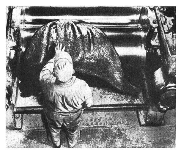
Eine der grossen Walzmaschinen. Der Rohkautschuk wird zwischen schweren Stahlwalzen durchgepresst, damit er weich, d.h. plastisch wird.
