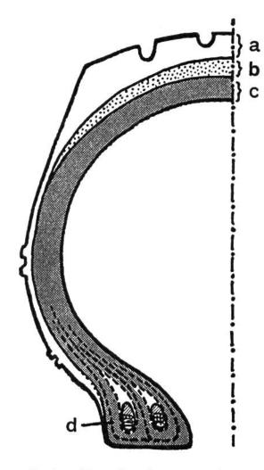
Autoreifen im Querschnitt. a Lauffläche, b Zwischenbau aus Polstergummi mit Protektoreinlagen, c Unterbau aus Cord-Gummilagen mit Gewebeeinlagen, d Wulst mit Stahldrahteinlagen.
