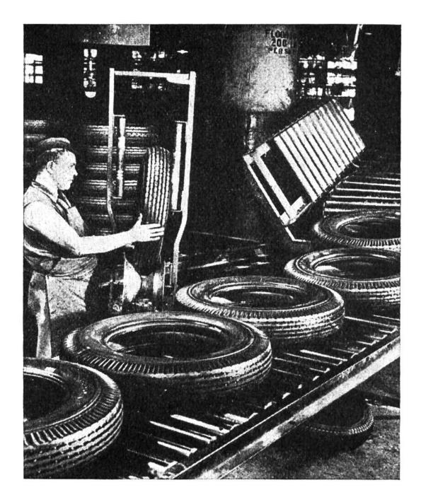
Nach einer letzten genauen Prüfung gelangen die versandfertigen Reifen auf einem Fliessband in die Lagerräume.
