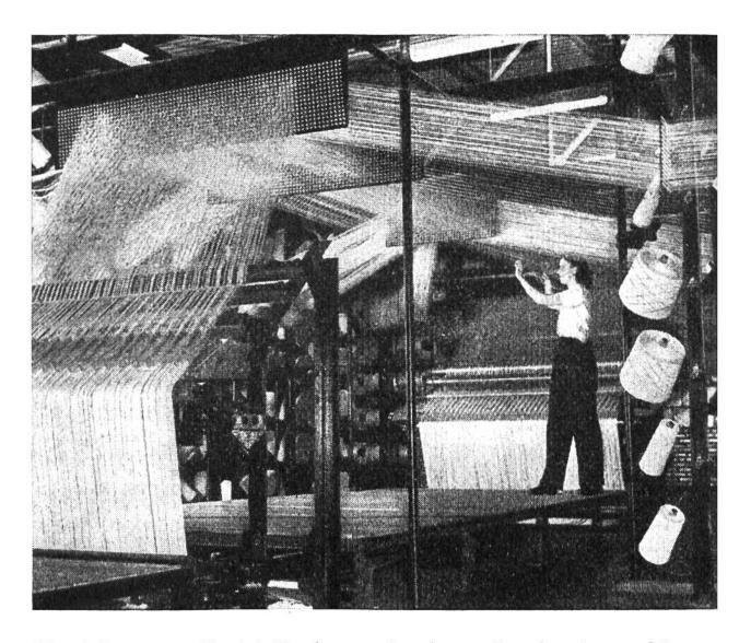
Herstellung von Cordstoff, einem schusslosen Gewebe, dessen Längsfäden von Gummi umgeben sind und dadurch zusammengehalten werden. Der aus mehreren Baumwoll- oder Kunstseidenfäden gedrehte Cordfaden besitzt eine grosse Zerreissfestigkeit und Dehnbarkeit.
