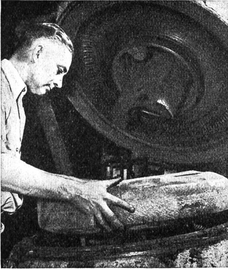
Einlegen des Gummireifens in die Vulkanisationsform. Unter Hitze und Druck wird der Lauffläche die gewünschte Profilierung eingepresst.
