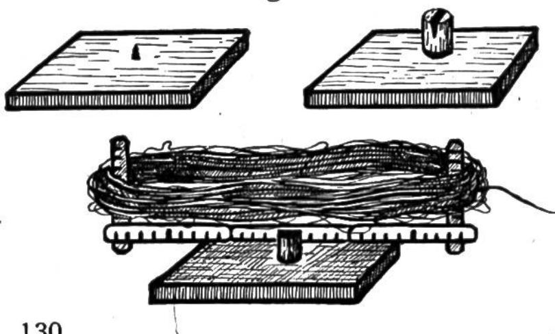
zapfen gesteckt, in den wir vorher oben einen Einschnitt gemacht haben. In den Einschnitt drücken wir einen Meterstab (siehe Abb.) und der Wollwinder ist fertig.
