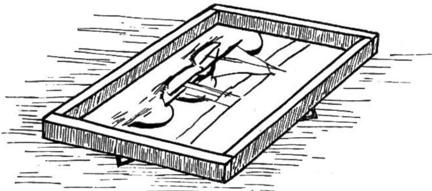
schneide sie auf die richtige Länge zu. Mit etwa 12 mm langen Nägeln nagle ich die vier Stücke zusammen, so dass der Rahmen mit der schmalen Seite auf das Bild geklebt werden kann. Das Bild muss eventuell zuerst auf einen Karton aufgezogen werden.
