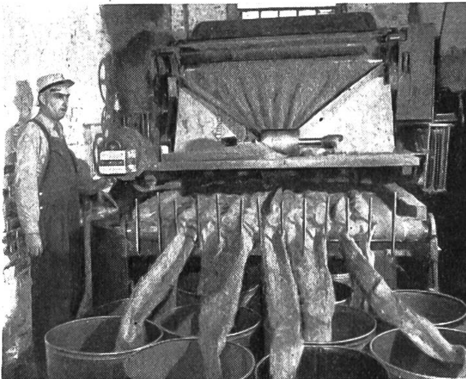
In der Spinnerei werden die zugerüsteten Fasern zunächst gespalten.
