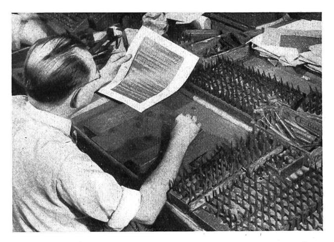
Korrektur anhånd eines Probeblattes: Alle Ungenauigkeiten werden von der Rückseite her flachgehämmert u. die Verbesserungen neu eingestanzt.
