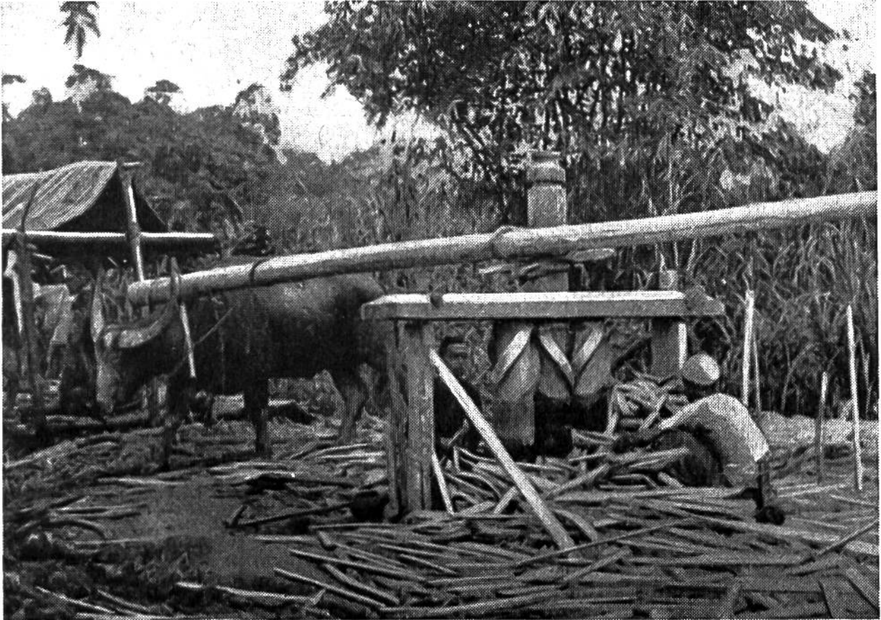
Eine primitive Zuckermühle der Malaien, die den süßen Saft aus dem Zuckerrohr presst.
