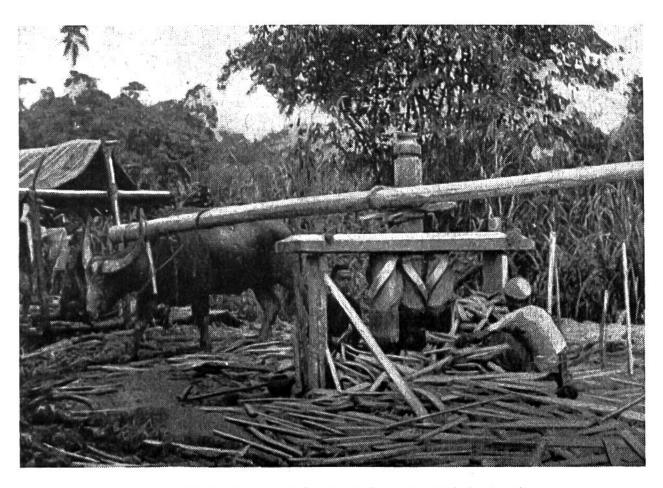
Eine primitive Zuckermühle der Malaien, die den süssen Saft aus dem Zuckerrohr presst.
