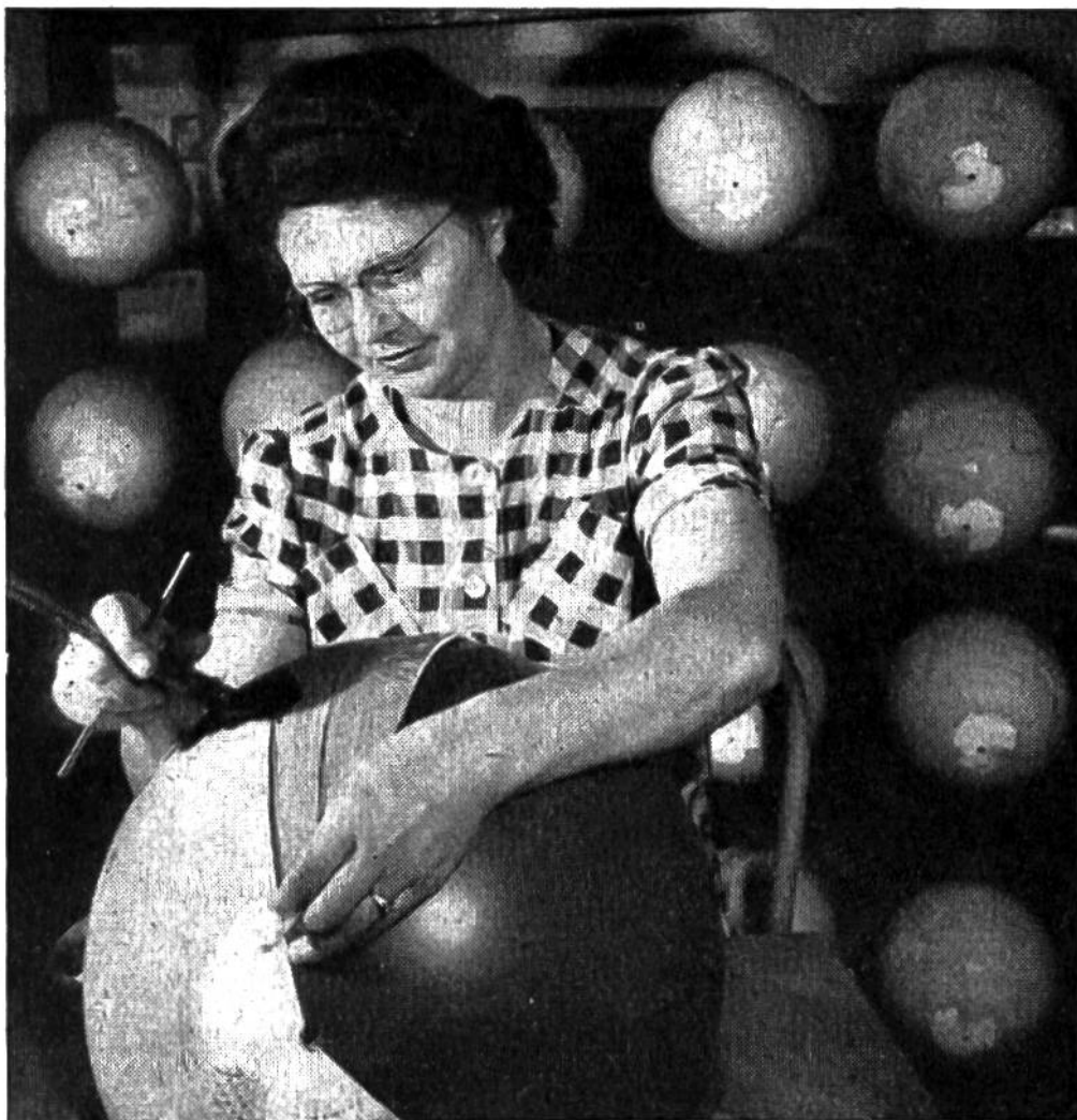
Das Aufkleben von 12 Kartenschnitzen und 2 Polkappen erfordert sorgfältige Handarbeit. Im Hintergrund Kugeln auf Trockengestell.
